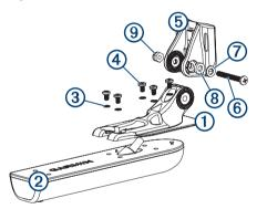
2 Fija el montaje al soporte (5) con el perno (6), la arandela plana (7), la arandela de goma (8) y la tuerca de fijación (9).
